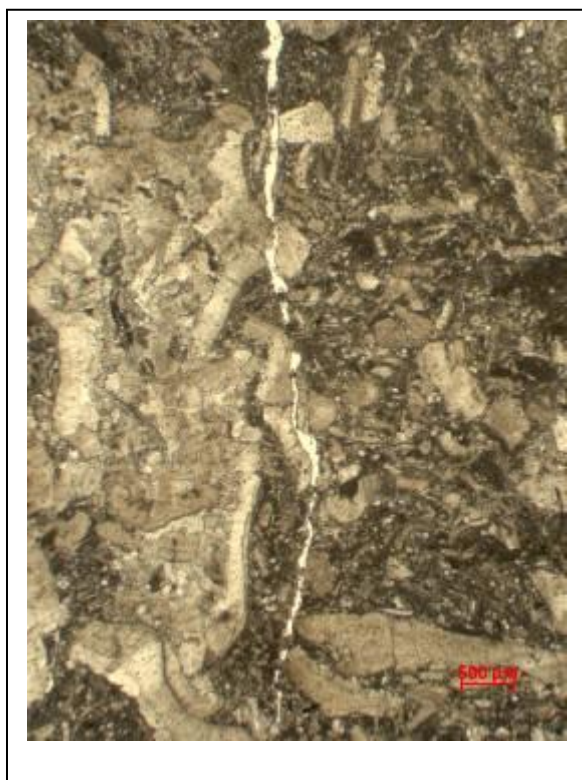
Foto IVC2-1: fissures in grainstone .
